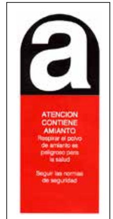
Figura 8. Etiquetado de los productos que contengan amianto.
